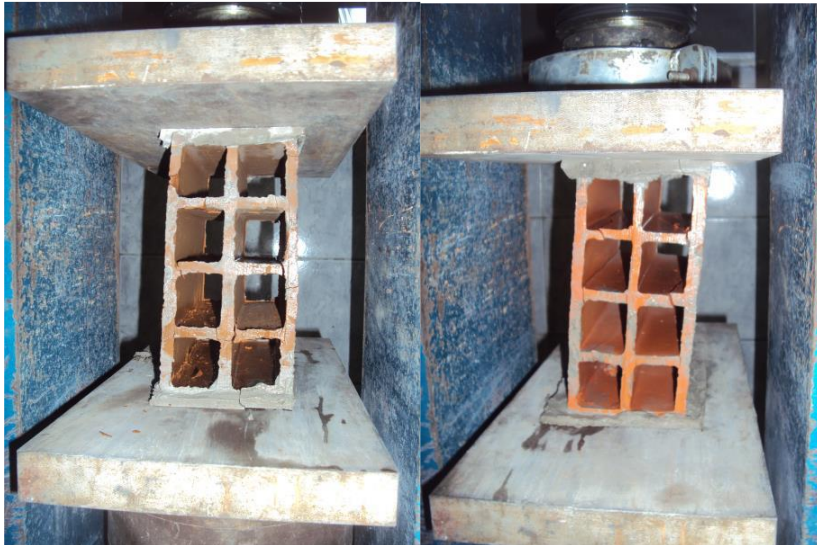
Figura 1. Ensaio de compressão axial. Figura 2. Rompimento do bloco no ensaio.
