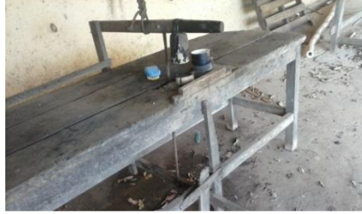
Figura 6. Imagem da maquina manual utilizada para fazer as bolotas de ração para os pirarucus.
