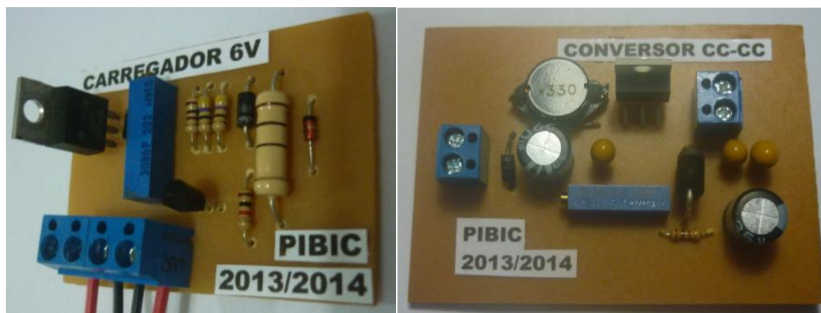
Figura 4. (a) Carregador de 6V e (b) conversor buck CC-CC prontos para utilização.
