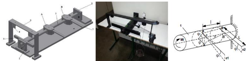
Figura 4. Equipamento fabricado para ensaio de Torção em barras circulares e diagrama de análise dos deslocamentos, respectivamente.
