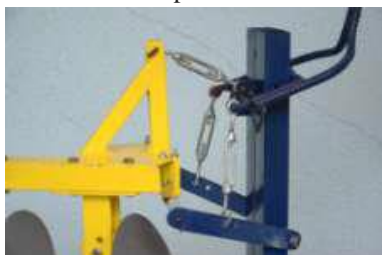
Figura 2. Detalhe dos braços de nivelamento longitudinal (terceiro ponto) e transversal (braços inferiores).
