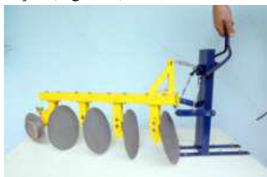
Figura 1. Arado em miniatura acoplado ao sistema de levante acionado manualmente por uma alavanca.
