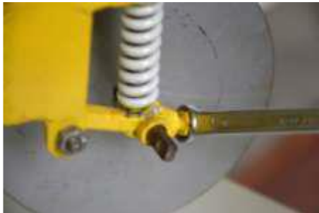
Figura 7. Detalhe da liberação do eixo da roda.
