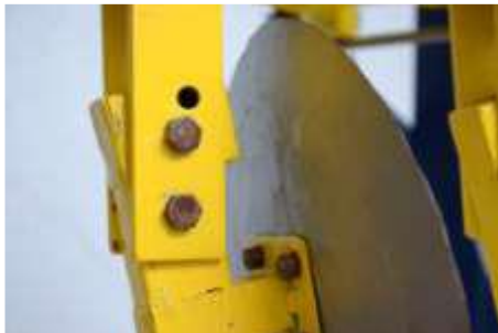
Figura 13. Detalhe da fixação do pedestal do disco ao chassi no maior ângulo vertical.
