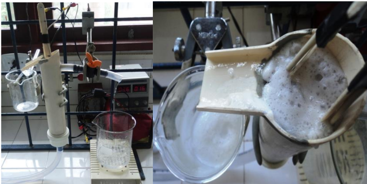
Figura 6. Reator tubular em funcionamento, sob o processo da eletrofloculação.
