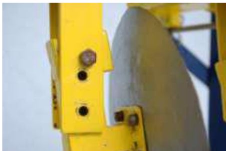
Figura 14. Detalhe da fixação do pedestal do disco ao chassi no menor ângulo vertical.
