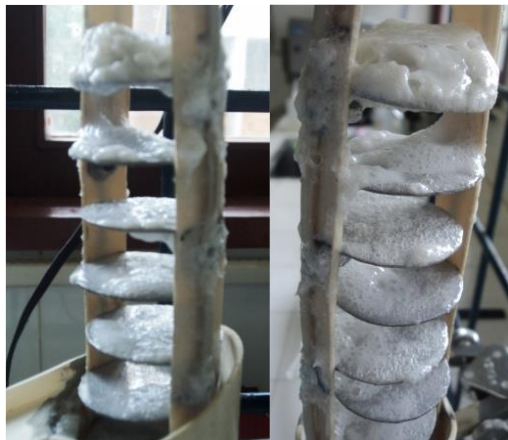
Figura 5. Deposição de sólidos – eletrofloculação.
